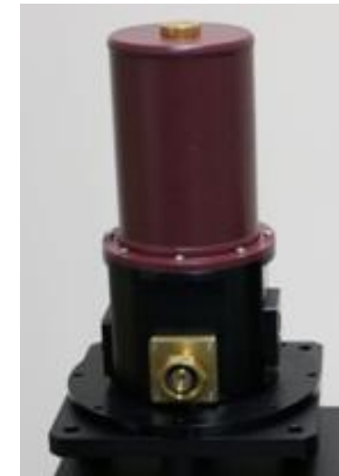
液体窒素冷却光源システム 時間平均出力 \sim 3 \mu\text{W}
