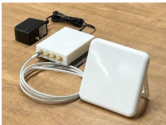
図 1 WPT 送電機とアンテナ
