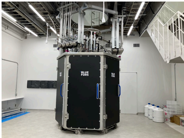
図 Bluefors 社製希釈冷凍機 KIDE (Qubed, G-QuAT)
