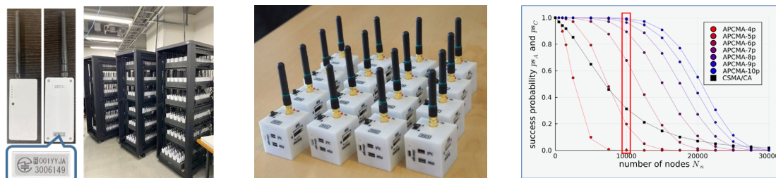
図 2. (左) STD-T108 規格に従い APCMA 方式を実装する 1500 台の送信機（東京理科大学）、（中央）微弱 315MHz の APCMA 実装（NICT）、（右）コンピュータ上でシミュレーションした、100～30,000 台の送信機と、符号語あたり 4～10 パルスの APCMA 符号を用いた場合の通信成功確率：10,000 台の送信機と 10 パルスの符号語の場合、成功率がほぼ 100%（NICT）
