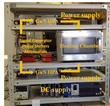
図2 GaN パワーアンプを用いた半導体マイクロ波加熱システム
