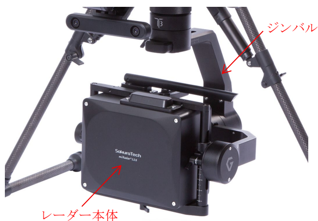
図 レーダーのドローン搭載例
