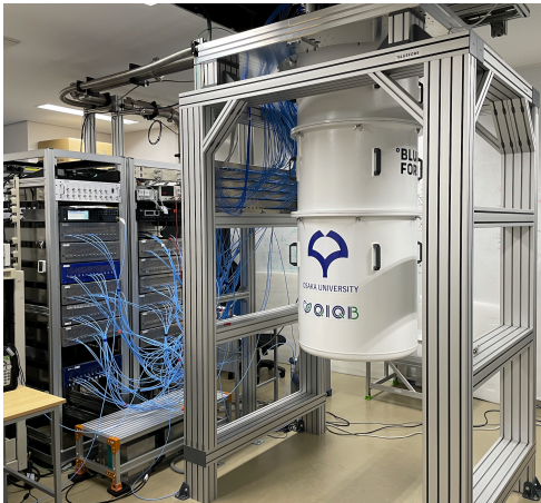
図1: 大阪大学 QIQB で稼働中の超伝導量子コンピュータ。
