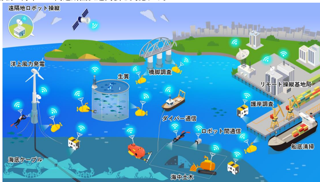
図 海中電波通信と海中ロボットの利用シーン
