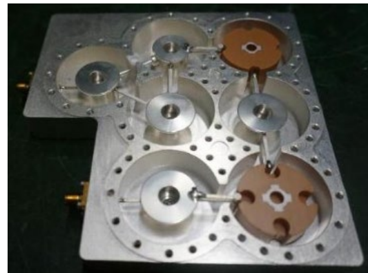
図 マルチモード誘電体共振器を用いた BPF
