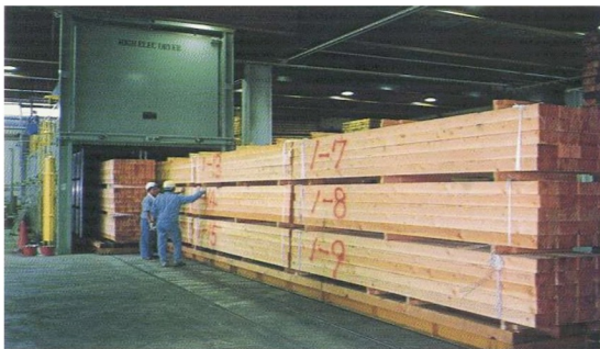
図1 減圧式高周波木材乾燥装置 13.56MHz 200kW
