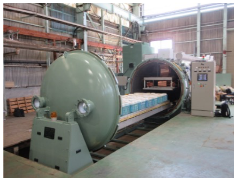
図2 減圧式高周波繊維乾燥装置 13.56MHz 100kW
