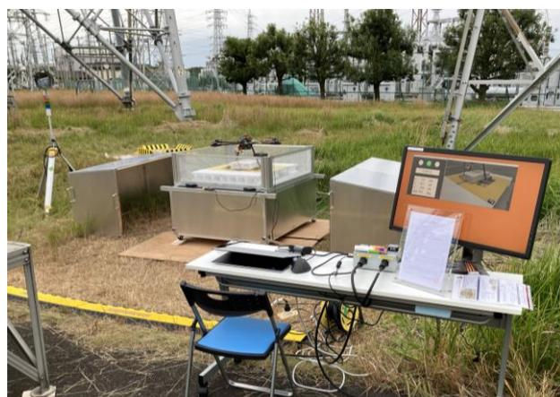
図2 ワイヤレスドローン充電システムの全体像
