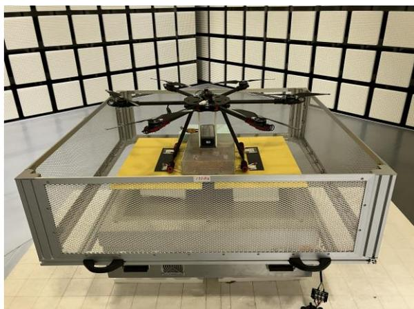
図1 電界結合ワイヤレスドローン充電システム
