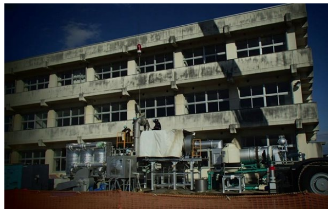
図 80 -120 kg/hour 処理可能なマイクロ波加熱炉
