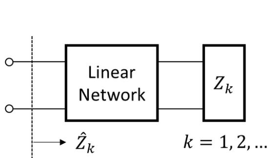
図 ある負荷に線形回路を接続することは複素平面上におけるメビウス変換を表す
