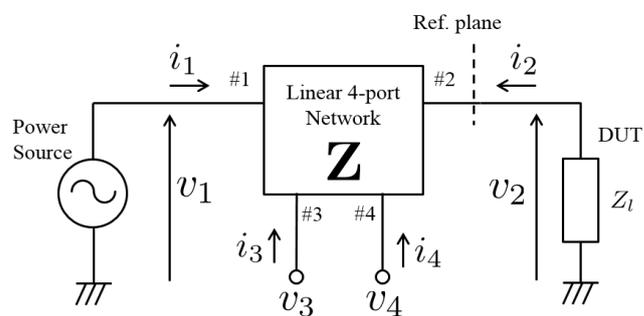
図 線形回路網と 2 つの電圧測定端子で非線形負荷インピーダンスを測定する
