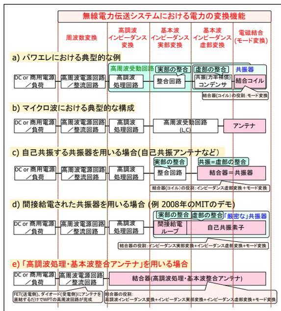
図 無線電力伝送システムにおける電力の変換機能と、結合器(アンテナ)の役割
