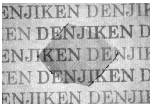
図 1 光透過性を有する \text{Fe}_9\text{Co}_5\text{Al}_{19}\text{F}_{67} ナノグラニューラー膜
