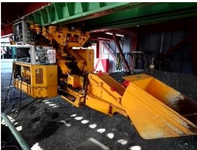
建設機械向け 15kW WPT システム
