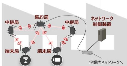
図 高信頼マルチホップ無線 LAN 構成
