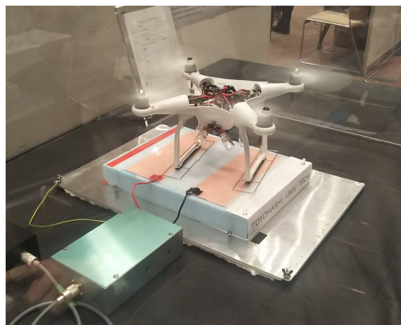
図2 小型ドローンへの 100W 給電実験
