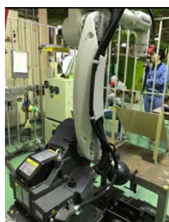
(a) オムロンのロボット (b) 多段非接触給電 図 II アームロボットへの非接触給電
