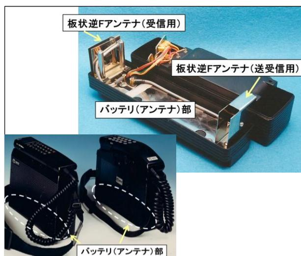
図B 逆Fアンテナの実装例(ショルダーホン)
