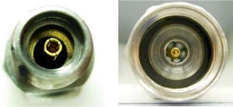
図 5-5. (左)飛び出し (右)中央位置ずれ
