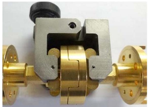
図 10 ミリ波・テラヘルツ用高精度導波管[14]
