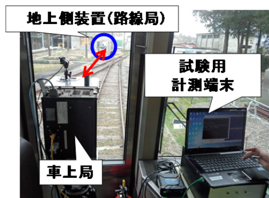
鉄道総研 所内試験線における 90GHz 帯試作無線機による対列車通信実験の様子
