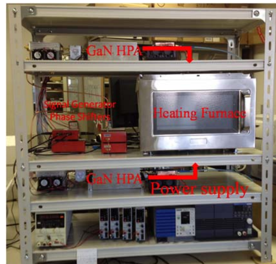
図2 マイクロ波加熱システムの外観写真
