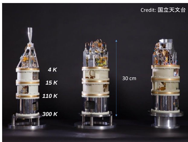
図1 日本の国立天文台が開発したアルマの受信機カートリッジの写真。左:バンド4 (125-163GHz), 中: バンド8 (385-500 GHz), 右: バンド10 (787-950 GHz)。
